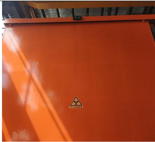
图 4-7 电离辐射警告标志和工作状态警示灯
