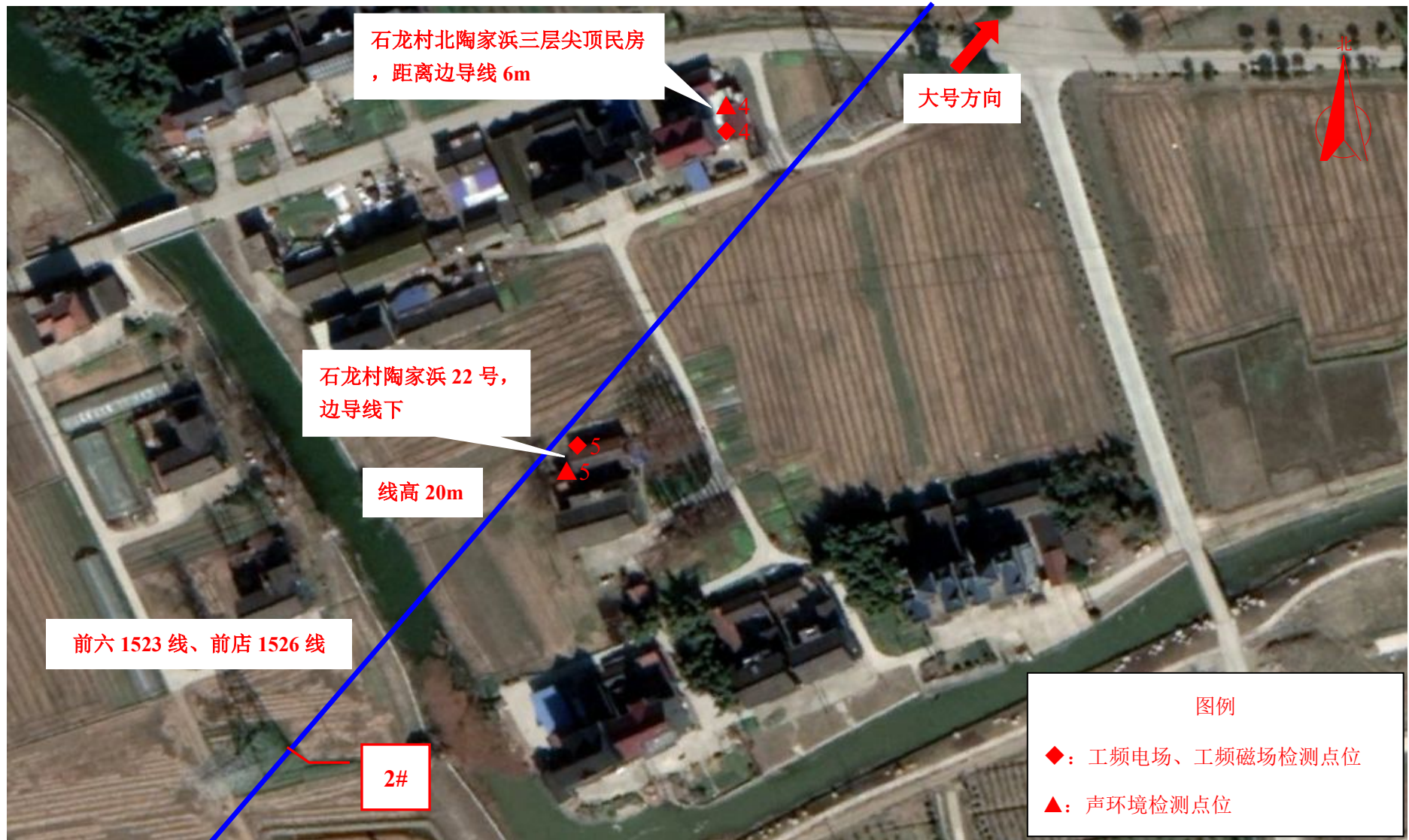
图 7-1 (3) 现场监测点位图 (110kV 六店输电线路工程)
