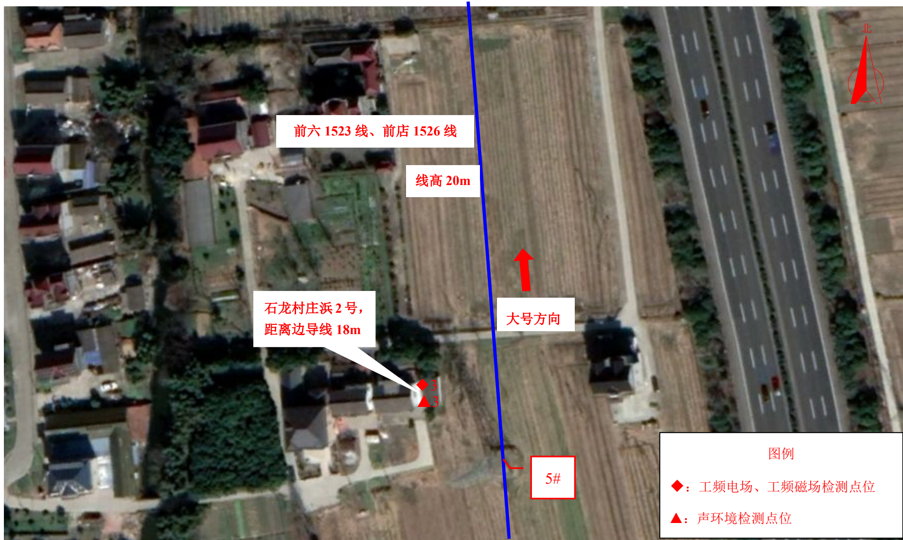
图 7-1 (2) 现场监测点位图 (110kV 六店输电线路工程)
