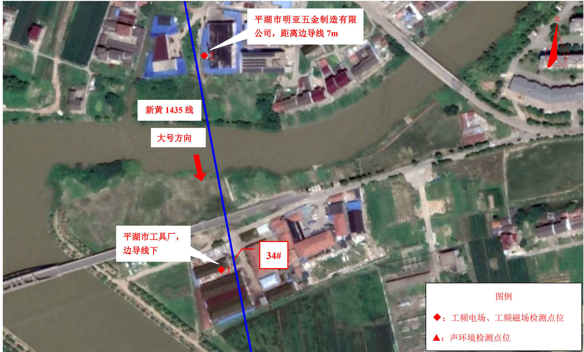
图 7-2 (1) 现场监测点位图 (110kV 黄姑输电线路工程)
