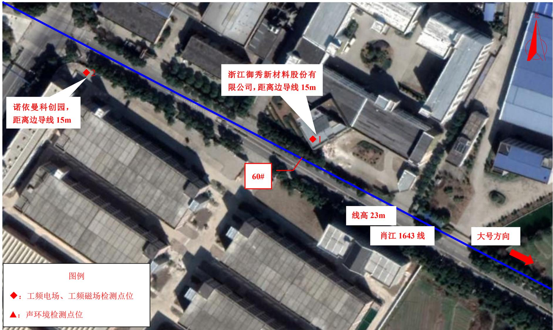
图 7-1 (1) 现场监测点位图 (110kV 肖江 1643 线/南丰 1215 线/南丰 1215 江南支线输电线路工程)
