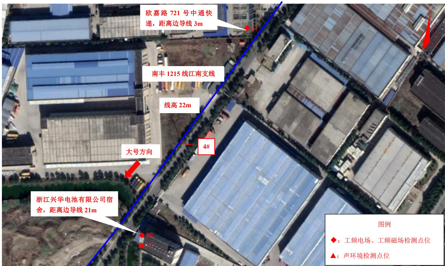
图 7-1 (19) 现场监测点位图 (110kV 肖江 1643 线/南丰 1215 线/南丰 1215 江南支线输电线路工程)
