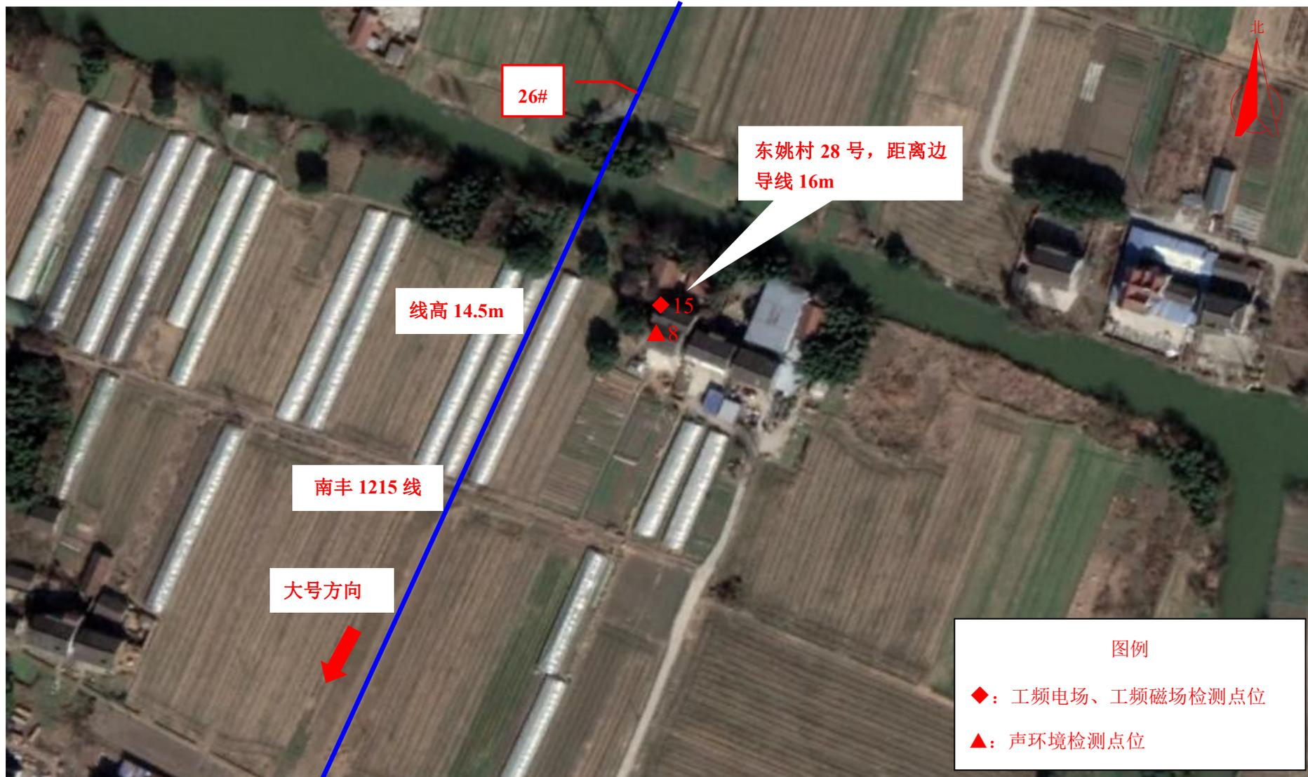
图 7-1 (10) 现场监测点位图 (110kV 肖江 1643 线/南丰 1215 线/南丰 1215 江南支线输电线路工程)
