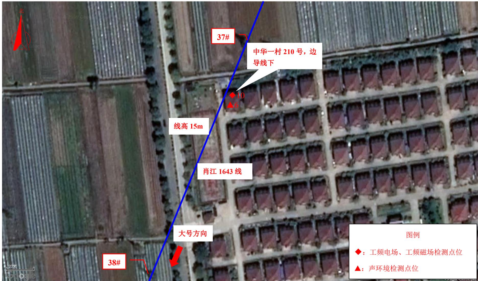
图 7-1 (7) 现场监测点位图 (110kV 肖江 1643 线/南丰 1215 线/南丰 1215 江南支线输电线路工程)
