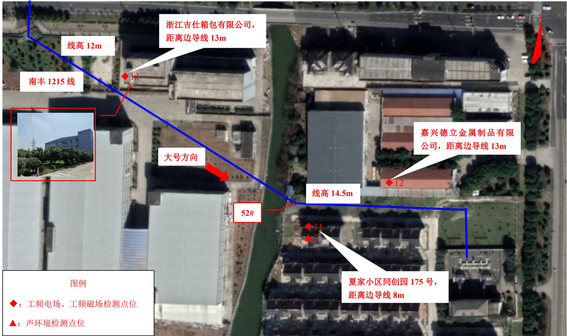
图 7-1 (8) 现场监测点位图 (110kV 肖江 1643 线/南丰 1215 线/南丰 1215 江南支线输电线路工程)
