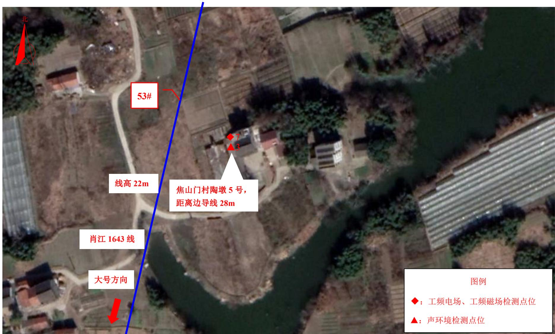
图 7-1 (5) 现场监测点位图 (110kV 肖江 1643 线/南丰 1215 线/南丰 1215 江南支线输电线路工程)
