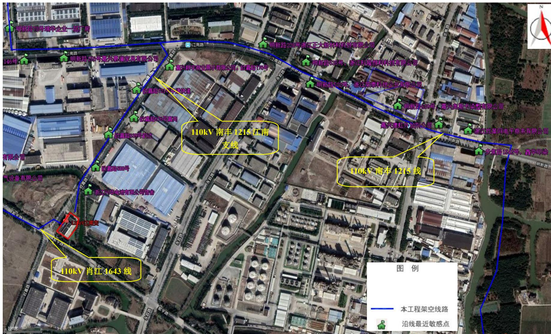
图 4-2 (4) 工程线路路径图 ( 110kV 肖江 1643 线、 110kV 南丰 1215 线、 110kV 南丰 1215 江南支线)
