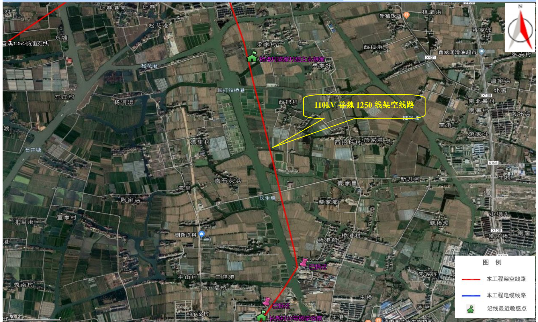
图 4-7 (7) 工程线路路径图 (110kV 善魏 1250 线/云魏 1424 线)
