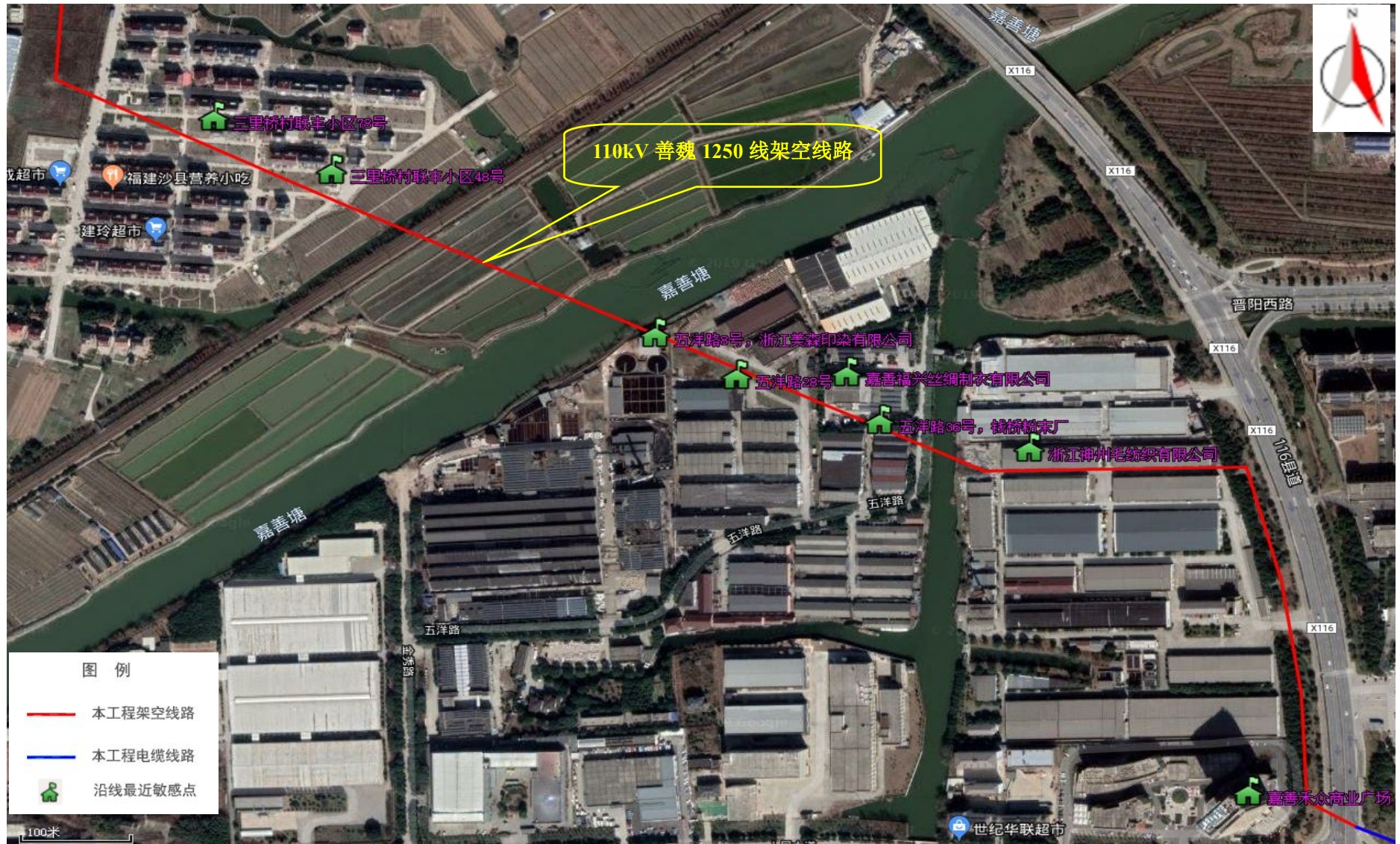
图 4-7 (5) 工程线路路径图 (110kV 善魏 1250 线/云魏 1424 线)
