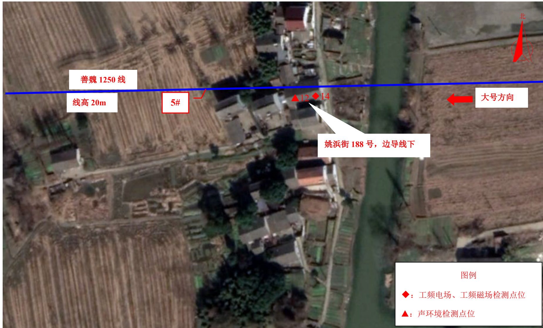
图 7-3 (9) 现场监测点位图 (110kV 魏塘输变电工程)
