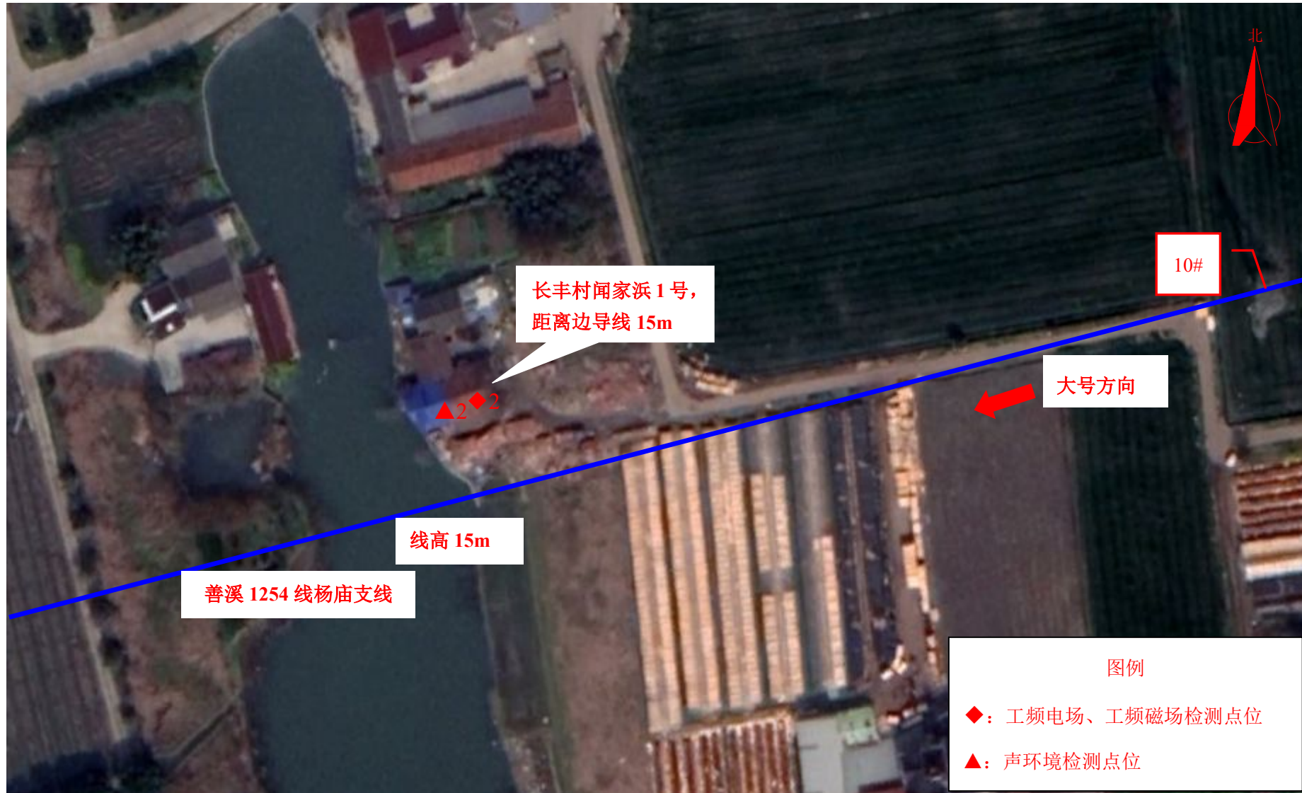
图 7-5 (2) 现场监测点位图 (110kV 善溪 1254 线/善溪 1254 杨庙支线输电线路工程)
