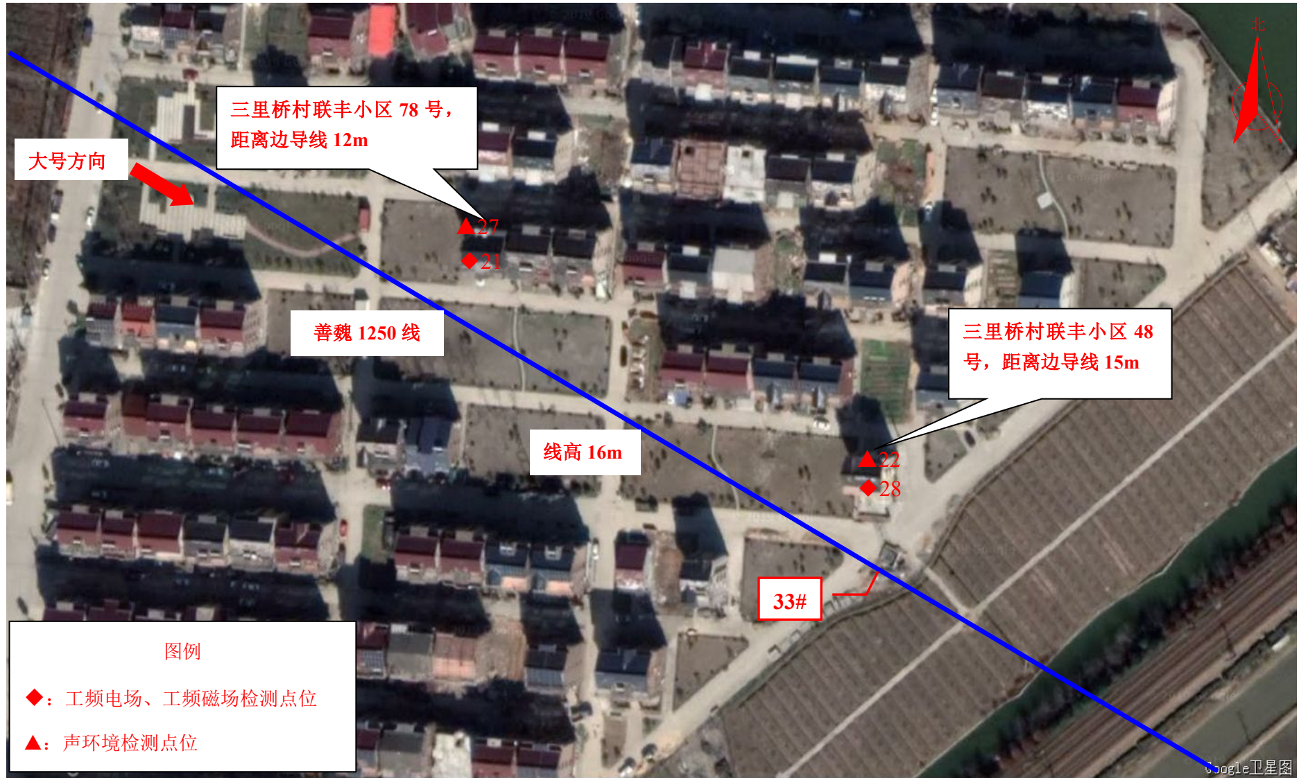
图 7-3 (17) 现场监测点位图 (110kV 魏塘输变电工程)
