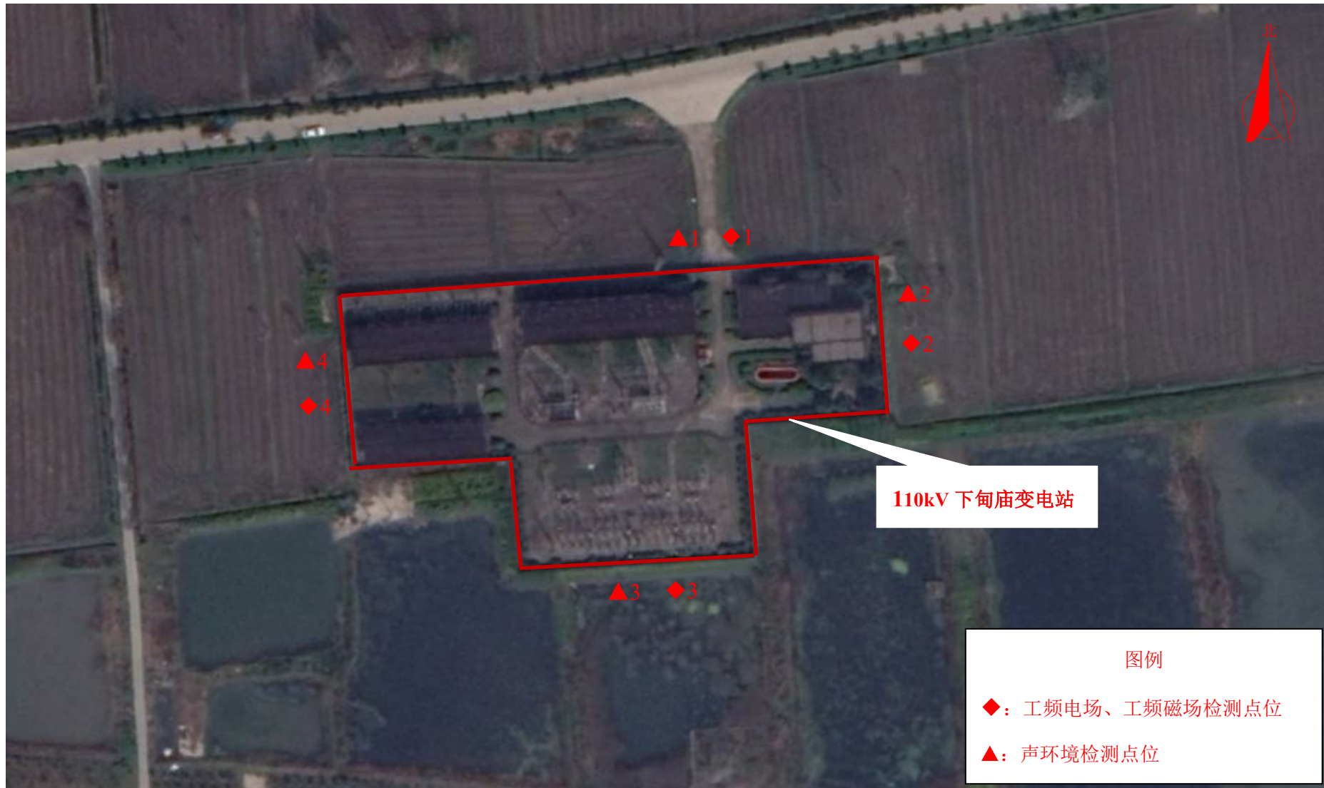
图 7-4 (1) 现场监测点位图 (110kV 下甸庙输变电工程)
