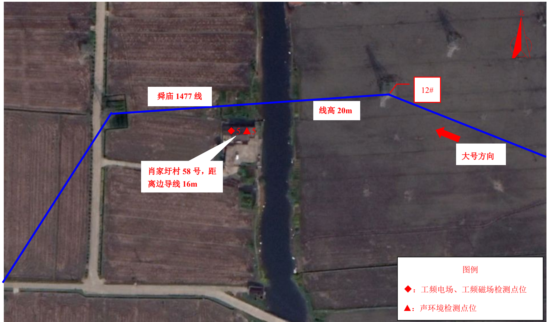
图 7-4 (2) 现场监测点位图 (110kV 下甸庙输变电工程)
