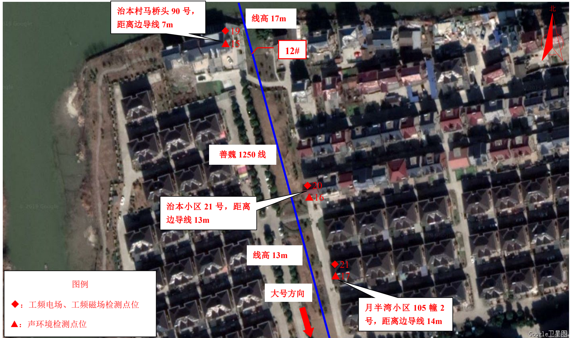
图 7-3 (13) 现场监测点位图 (110kV 魏塘输变电工程)
