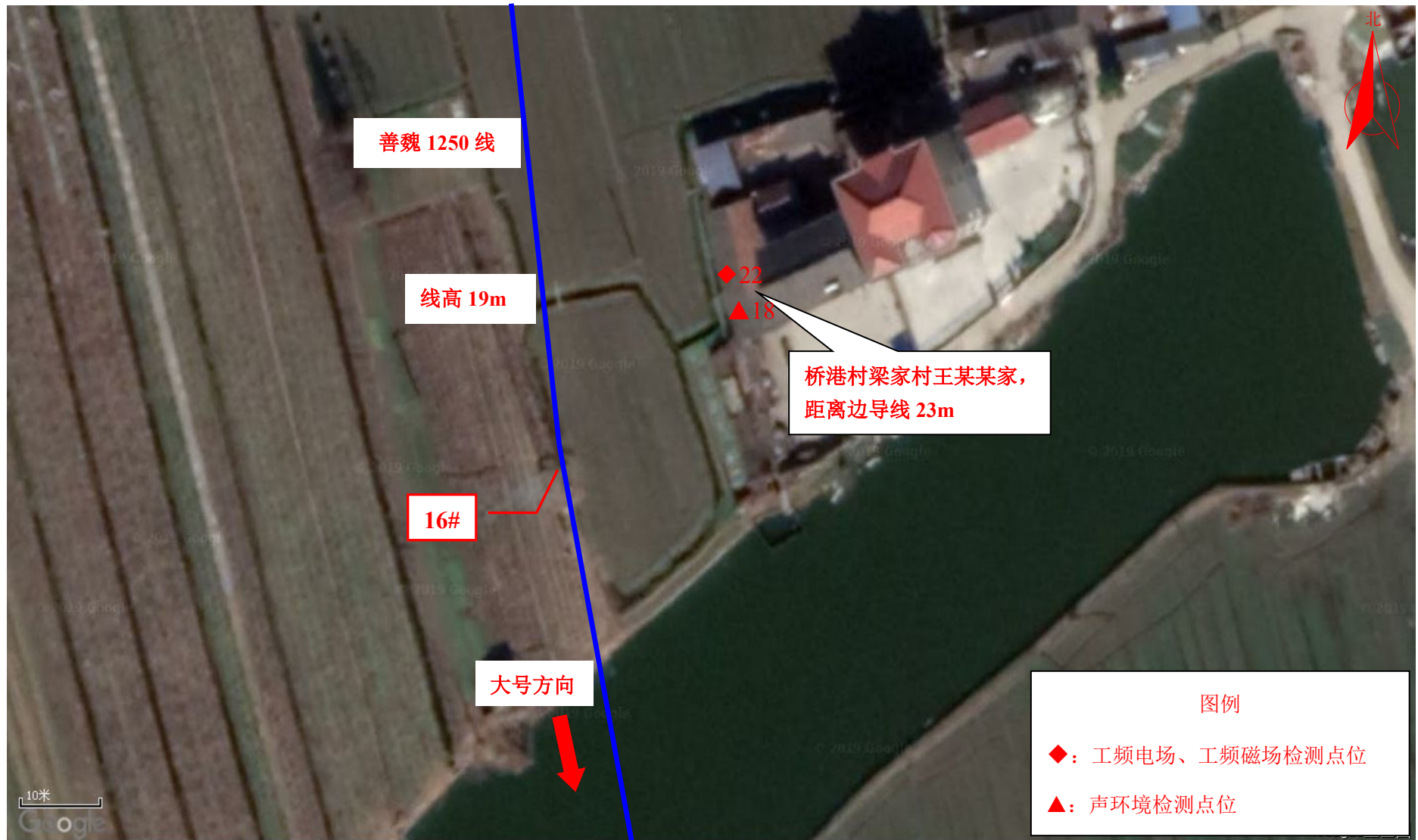
图 7-3 (14) 现场监测点位图 (110kV 魏塘输变电工程)
