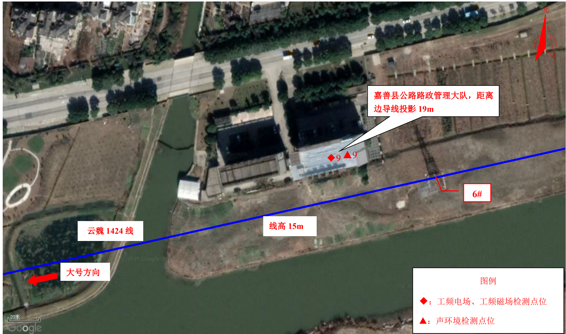
图 7-3 (4) 现场监测点位图 (110kV 魏塘输变电工程)
