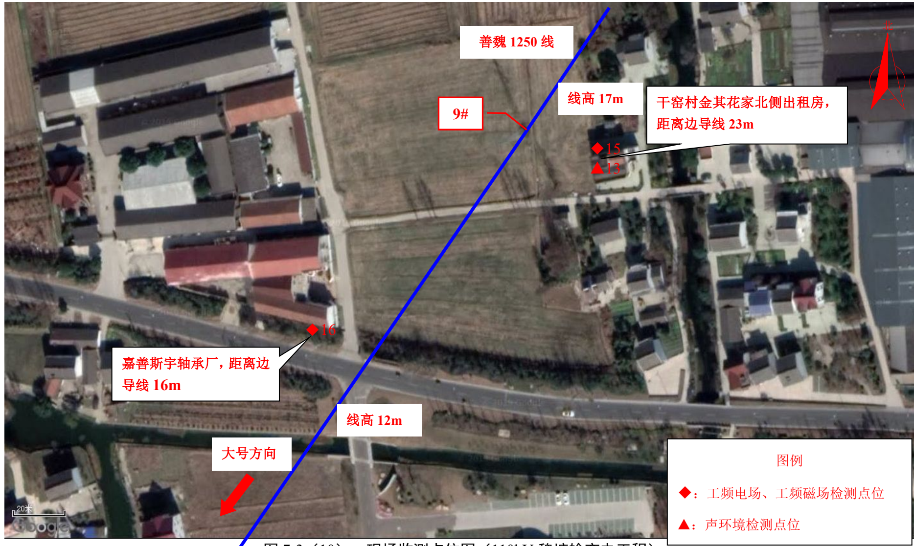
图 7-3 (10) 现场监测点位图 (110kV 魏塘输变电工程)
