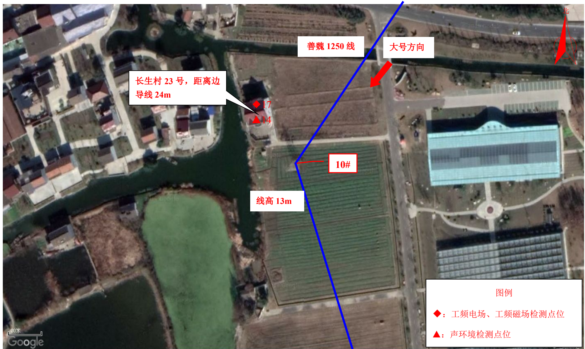
图 7-3 (11) 现场监测点位图 (110kV 魏塘输变电工程)
