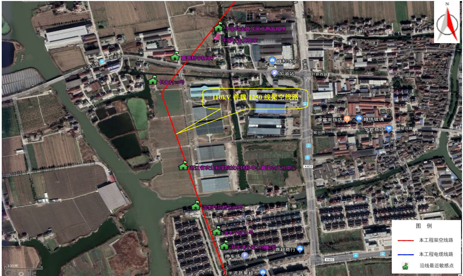
图 4-7 (8) 工程线路路径图 (110kV 善魏 1250 线/云魏 1424 线)
