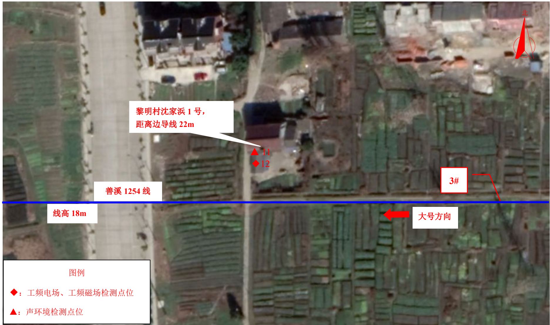
图 7-5 (11) 现场监测点位图 (110kV 善溪 1254 线/善溪 1254 杨庙支线输电线路工程)
