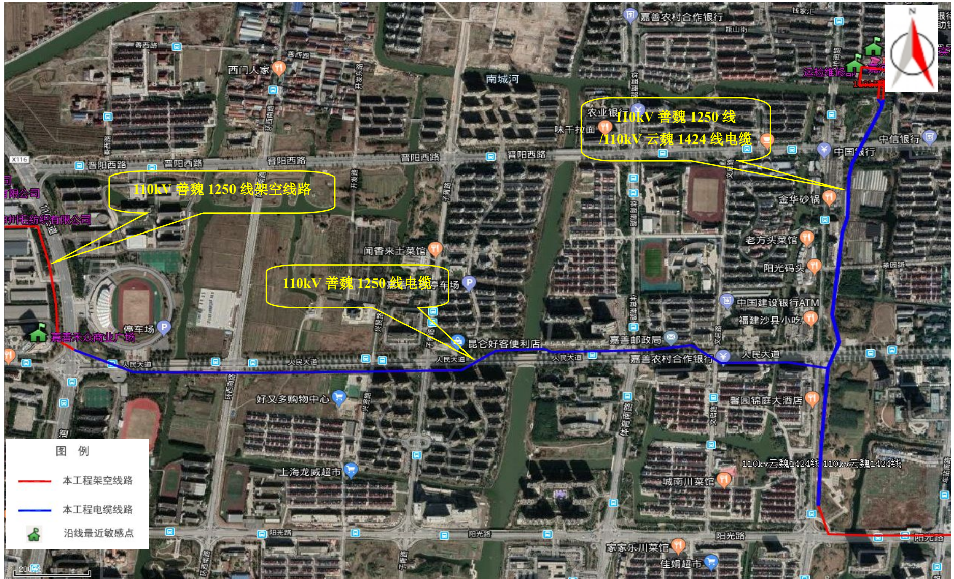
图 4-7 (4) 工程线路路径图 (110kV 善魏 1250 线/云魏 1424 线)
