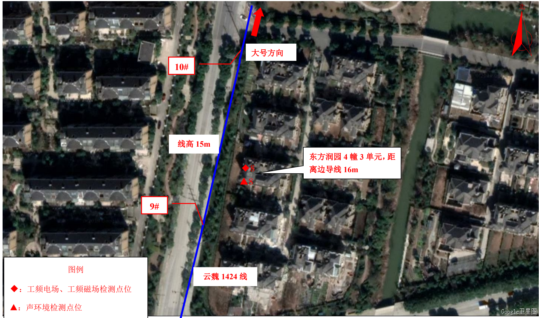
图 7-3 (3) 现场监测点位图 (110kV 魏塘输变电工程)
