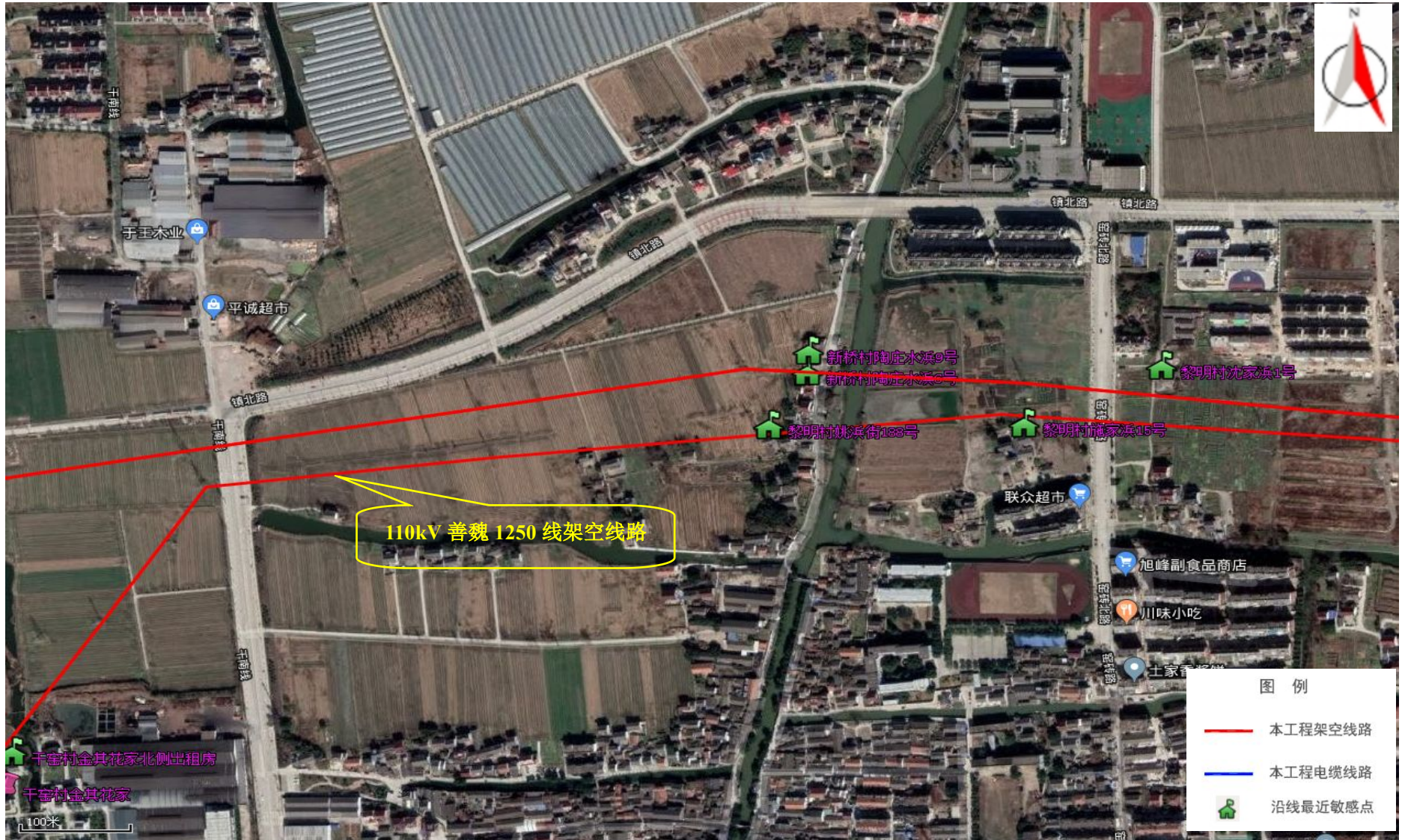
图 4-7 (9) 工程线路路径图 (110kV 善魏 1250 线/云魏 1424 线)
