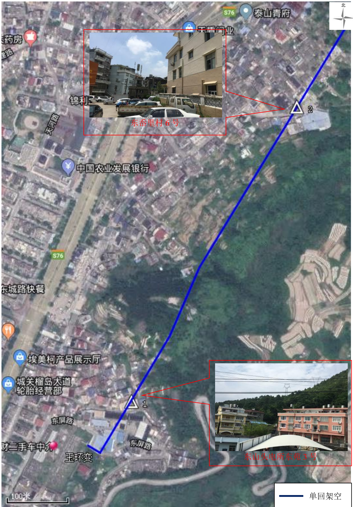
附图 3-10 110 kV 玉环输变电工程沙玉 1969 线 \Delta 1- \Delta 2 监测点位示意图
