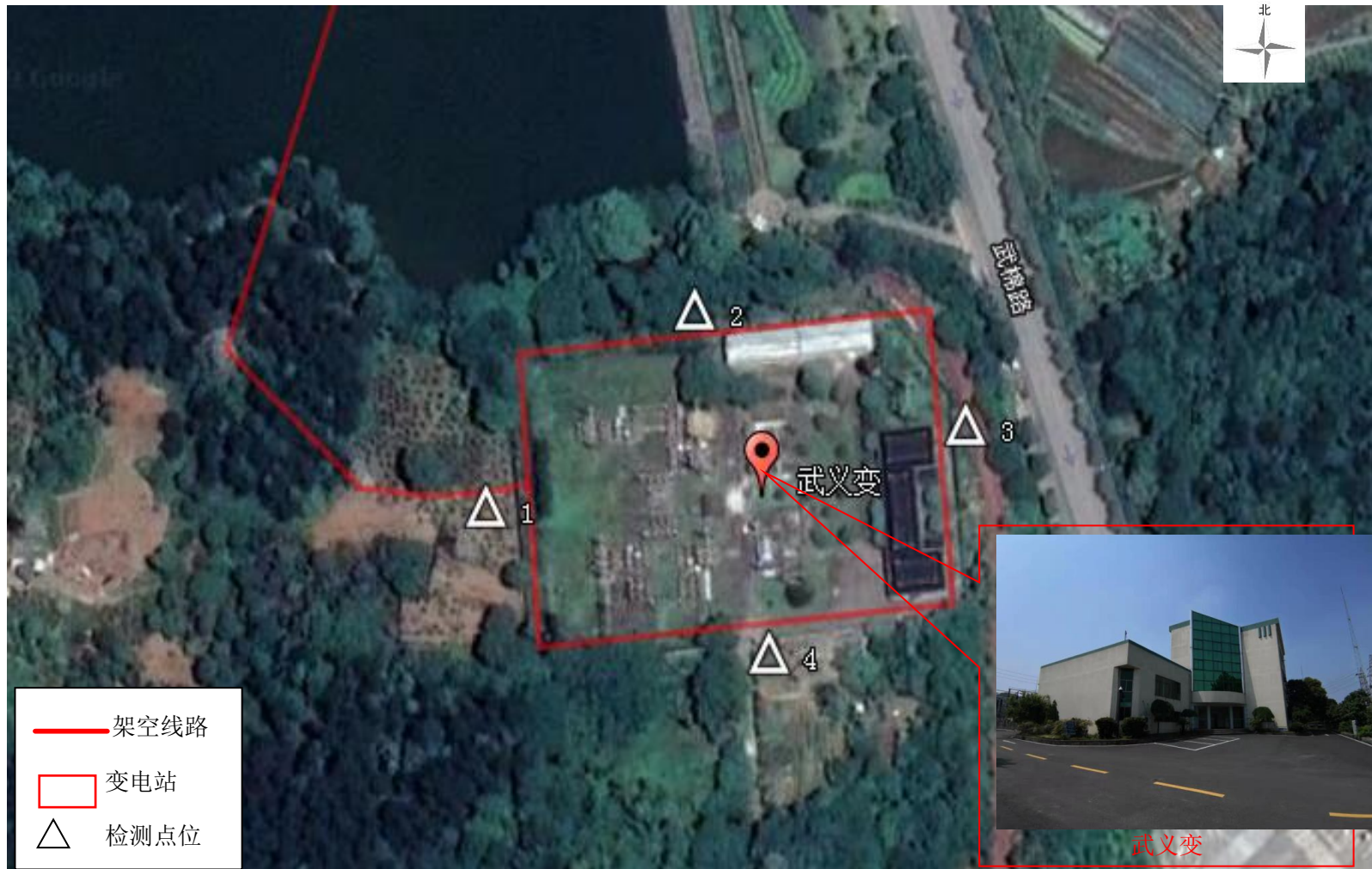
附图 3-1 武义变电站 \Delta 1- \Delta 4 检测点位示意图
