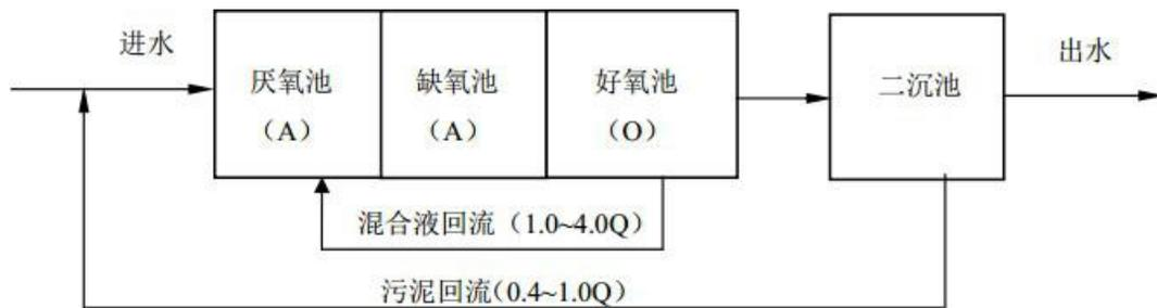
图 5-2 A/A/O 工艺流程框图
