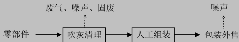
图 5-2 台灯生产流程及排污节点示意图
