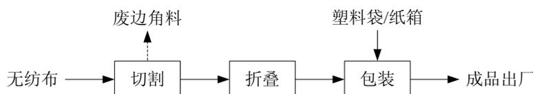
图 5-1 无纺布制品生产工艺流程图示意图
